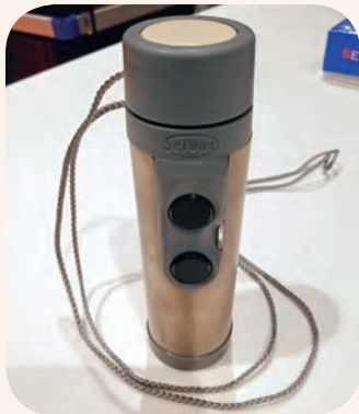
▲電咪是常見的發聲輔助工具，透過喉嚨附近肌肉震動發聲。
